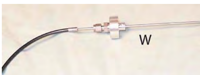
Fensteraufnehmer, nur die Spitze befindet sich im Vakuum, für bis zu 10e^{-7} Torr
