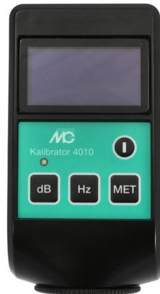
Der Schalldruckpegel wird mit einem internen Referenzsensor gemessen und nachgeregelt. Dadurch wird ein von der akustischen Last des Messmikrofons sowie von den Umgebungsbedingungen nahezu unabhängiger Schalldruckpegel im Kuppler des Kalibrators sichergestellt. Weiterhin misst der Kalibrator 4010 auch die Umgebungsbedingungen Temperatur, Luftdruck und relative Luftfeuchte.
